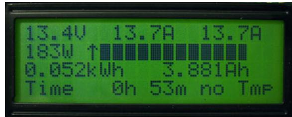
Normaler Anzeigen Modus mit größerem Strom und der Bargraph ist übersteuert (Pfeil).
